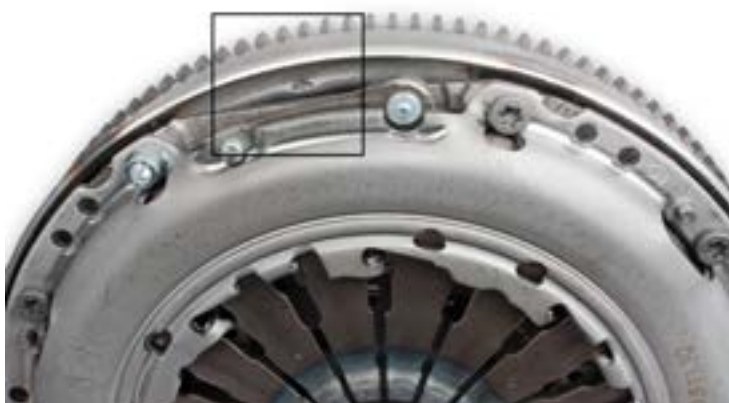
Fig. 1: Uzură cauzată de folosirea unui șurub prea lung
